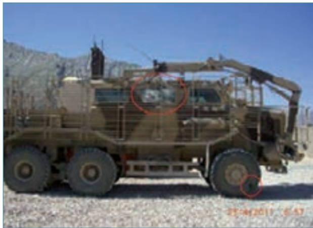
Des protections anti-RPG ont aussi été apportées au Buffalo, et elles se sont révélées utiles, sauvant un équipage essayant un tir de plusieurs roquettes. L'agrandissement montre les impacts 3 à 8.
