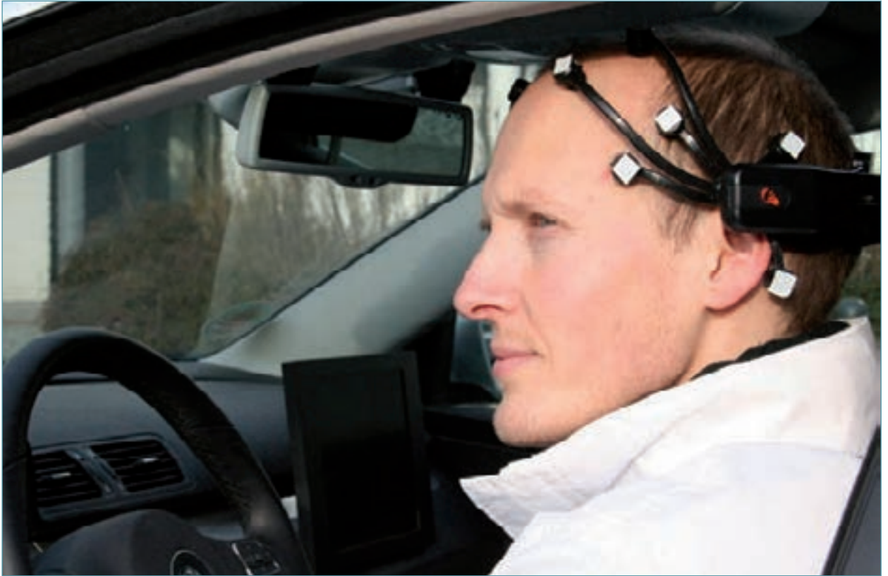
AutoNOMOS Labs, une équipe de recherche du laboratoire d'intelligence artificielle de l'Université Libre de Berlin explore les utilisations d'interfaces cerveau-ordinateur dans la conduite automobile
