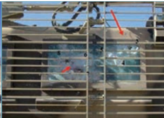
Des protections anti-RPG ont aussi été apportées au Buffalo, et elles se sont révélées utiles, sauvant un équipage essayant un tir de plusieurs roquettes. L'agrandissement montre les impacts 3 à 8.
