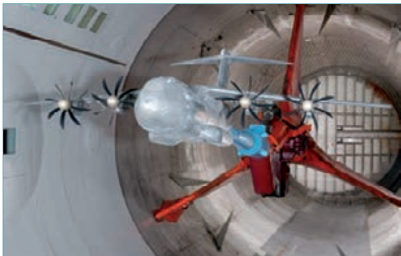
Maquette motorisée d'A400M dans la veine de la grande soufflerie transsonique S1MA à Modane.
