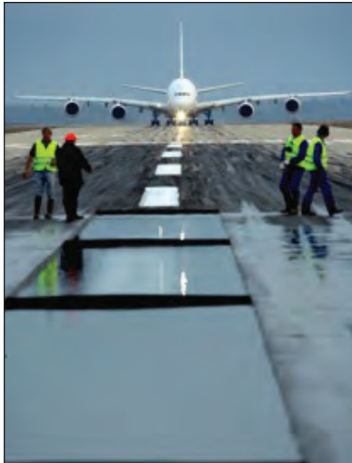
« essais piscine » : détermination de la vague de train avant qui doit rester hors des moteurs. Bassin central de la piscine, 25 cm seulement de plus que les 1m50 de large de la roulette avant !
