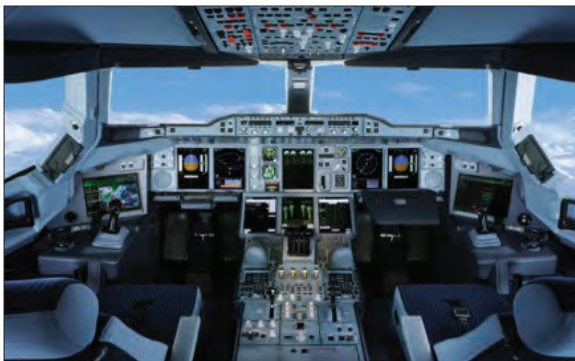
Vue intérieure du cockpit : 8 écrans interactifs et reconfigurables – simple et convivial
