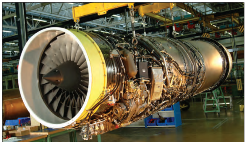
Moteur M53-P2 destiné au Mirage 2000
