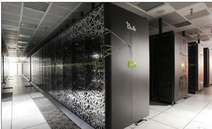
Le supercalculateur Tera-100, installé sur le centre CEA de Bruyères le Châtel, permet à la Direction des armes nucléaires de disposer d'une puissance de calcul de plus d'1 Pétaflops 1 .
