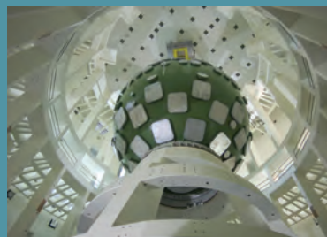
La fusion sera reproduite en vraie grandeur dans la chambre d'expérience du LMJ de 10 mètres de diamètre. De nombreuses autres catégories d'expériences indispensables à la garantie des armes, y seront aussi réalisées.
