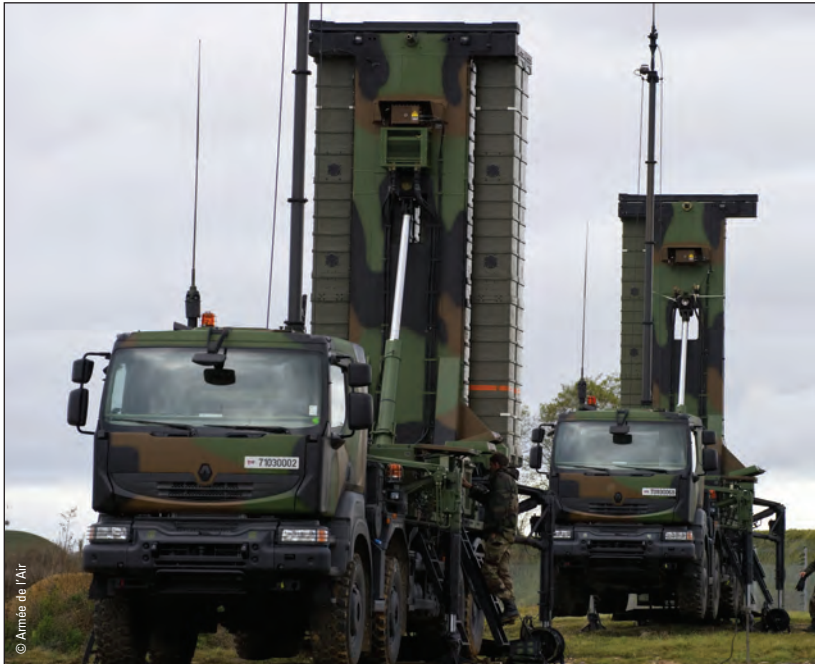
Deux lanceurs de missiles Aster du système SAMP/T (sol-air à moyenne portée/terrestre), désormais baptisé Mamba par l'armée de l'air française qui le met en œuvre, sont vus ici en protection de la base aérienne d'Avord lors d'un exercice récent.
