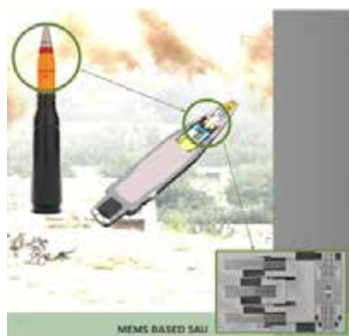
Pyro-MEMS® ayant subi l'accélération d'un tir canon: les propriétés mécaniques du silicium (plusieurs Giga-Pascal en limite à la rupture) et les masses infinitésimales en jeu permettent une grande robustesse.
