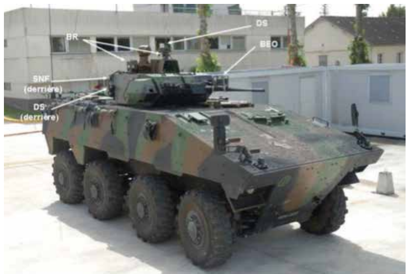
SIMULATION LIVE (ou instrumentée) Exemple du simulateur de tir de combat pour VBCCI
