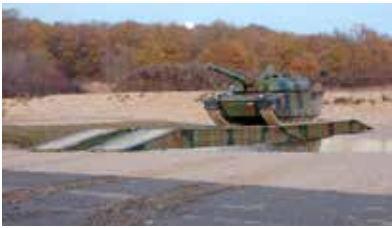
Franchissement d'un char Leclerc sur un pont long, jusqu'à 26 m de portée
