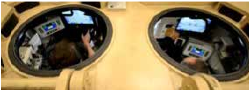
Vue du simulateur embarqué intégré dans une tourelle LCTS90 (CMI Defence)
