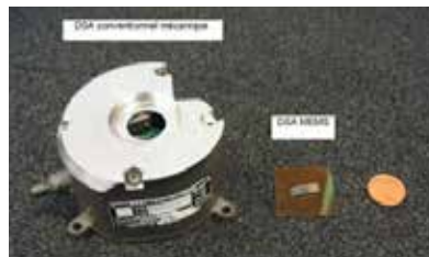
Côte à côte un Dispositif de Sécurité et d'Armement (DSA) missile conventionnel et le composant Pyro-MEMS® regroupant les mêmes fonctions
