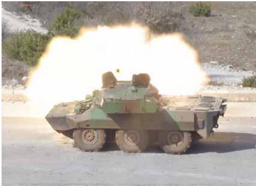
Tir d'un obus d'exercice (Boulet Simili Charge Creuse de 105 mm) par un AMX10 RC; volets ouverts, aux Amandiers sur le camp militaire de Canjuers
