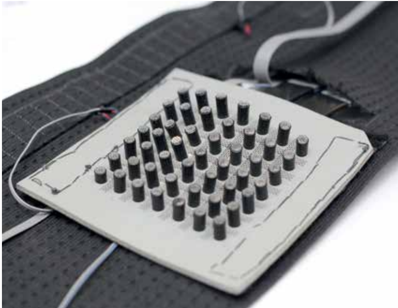
Dispositif matriciel constitué de 7x7 micro-vibrateurs délivrant des messages tactiles @Caylar
