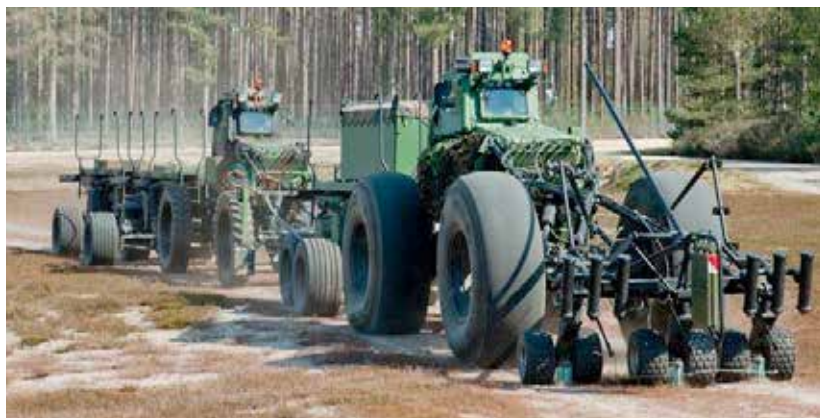
Véhicules SOUVIM (Système d'OUverture d'itinéraire Miné)
