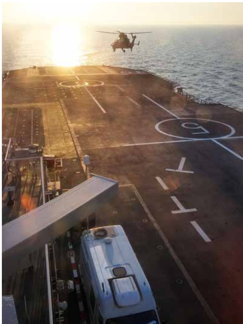
Campagne sur BPC — au premier plan le camion VERDICT permettant le suivi en temps réel des paramètres de l'appareil
