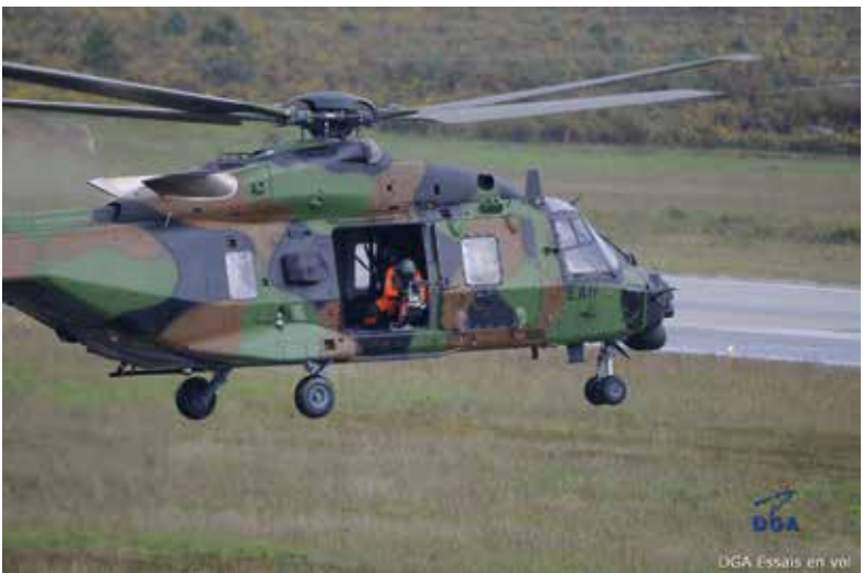
Essais d'intégration du fusil PGM sur Support d'Armement Assisté en sabord du NH 90
