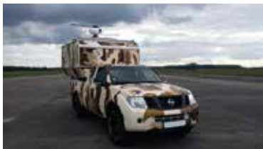
UAW – Unmanned Aerial Watchtower : drone IT180 adapté et intégré sur la plate-forme mobile pour l'application de « tour de guet » et « radio-relais »
