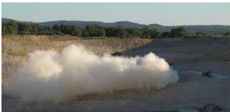
Prototype NH 90 MR1 en essai posé poussière dans la carrière de gypse et anhydrite SINIAT Mazan
