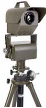
La caméra infrarouge Second Sight, permettant de détecter l'apparition d'un nuage de gaz chimique à distance
