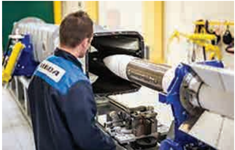
Fig. 1 : Insertion d'un missile Aster dans son tube de lancement
