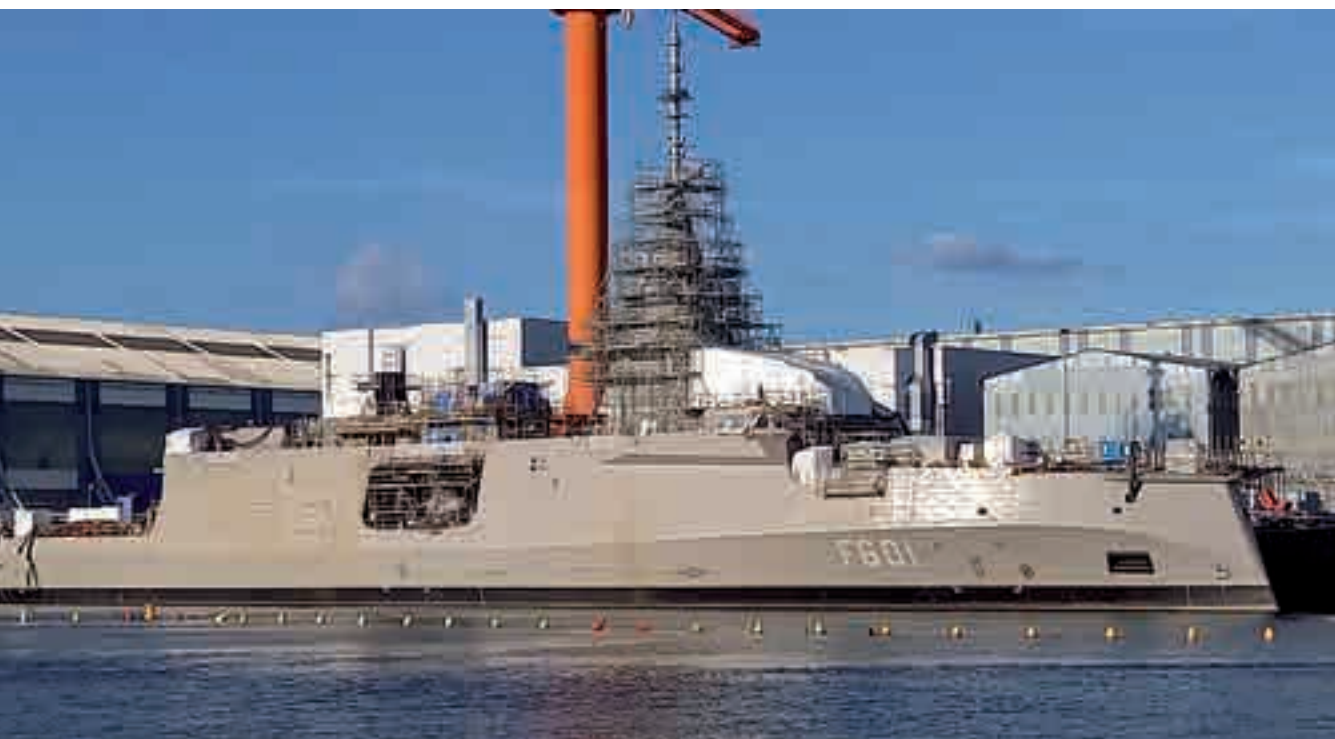
La frégate de défense et d'intervention (FDI) Kimon pour la marine grecque en cours d'achèvement au quai d'armement sur le site de Lorient de Naval Group. Le PSIM ( Panoramic sensor & intelligence module) qui contient notamment le radar et le central opérations est en cours de mise en place après son montage à terre indépendamment du flotteur. (L'Amiral Ronarc'h, tête de série des FDI pour la Marine nationale, est en période d'essai à la mer).
